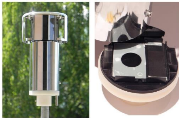
Figure 3 : Illustration du capteur passif de particules PM10
