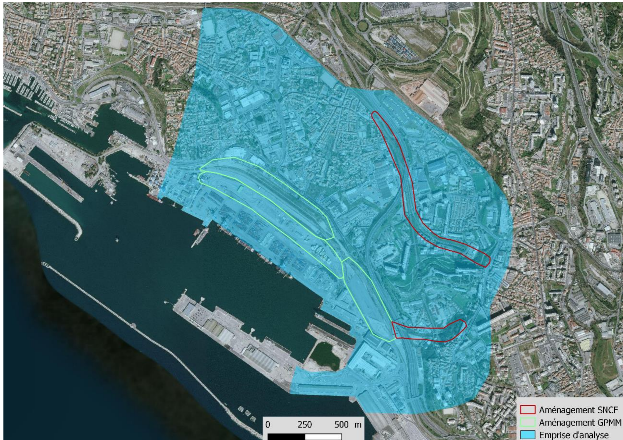
Figure 2 : Insertion des emprises du projet dans l'emprise d'analyse retenue, zones d'aménagements SNCF en rouge et GPMM en vert
