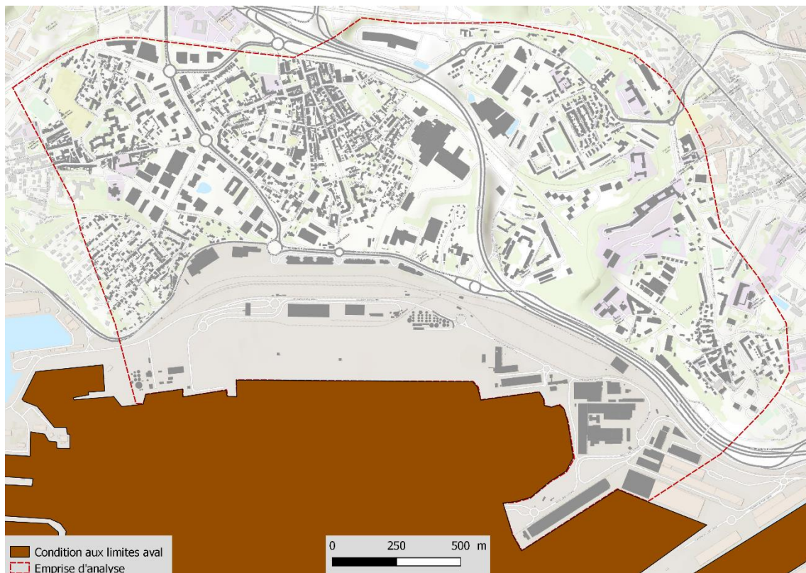
Figure 13 : Localisation des conditions aux limites aval de la zone d'étude (inférieure à 1.1m)
