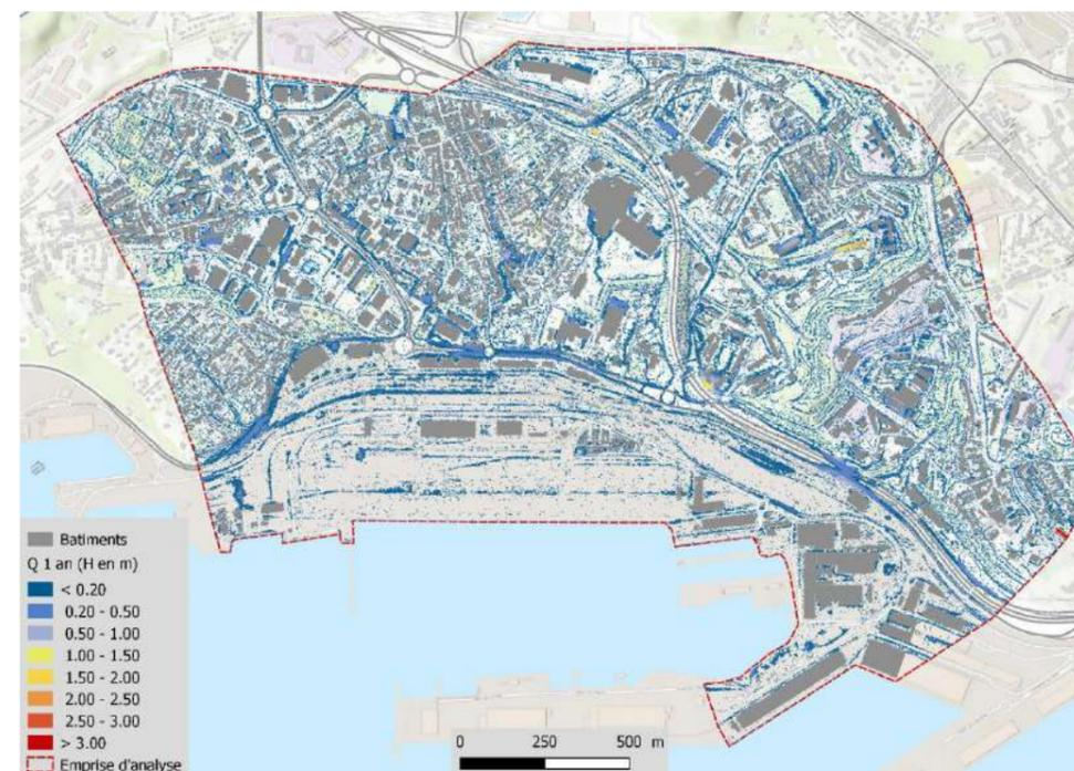
Figure 346 : Modélisation du réseau pluvial lors de fortes précipitations (retour 1 an)
