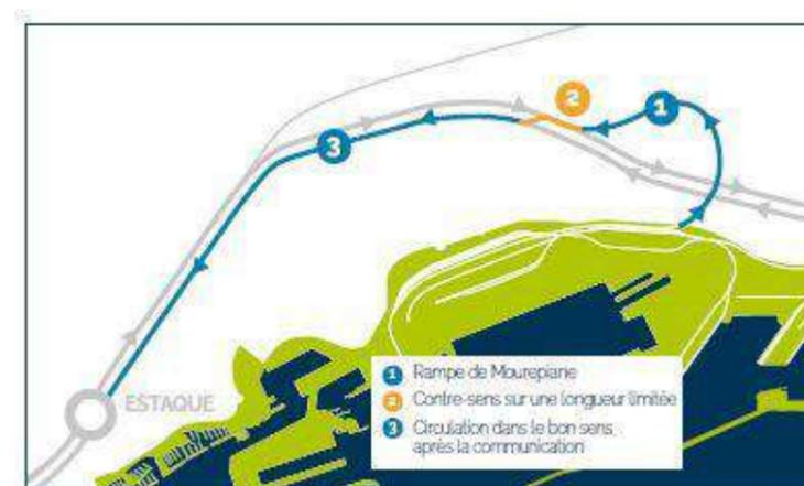
Figure 8 : Après 2030, zone de contresens réduite en sortie du raccordement, aiguillage permettant de reprendre la voie dans le bon sens
