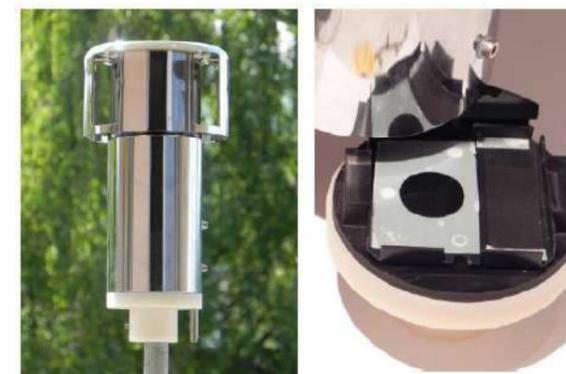
Figure 400 : Illustration du capteur passif de particules PM<sub>10</sub>
