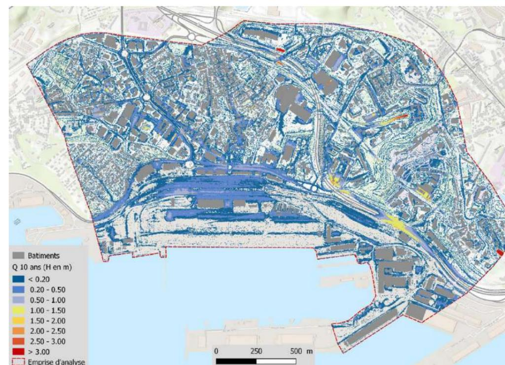
Figure 347 : Modélisation du réseau pluvial lors de fortes précipitations (retour 10 ans)
