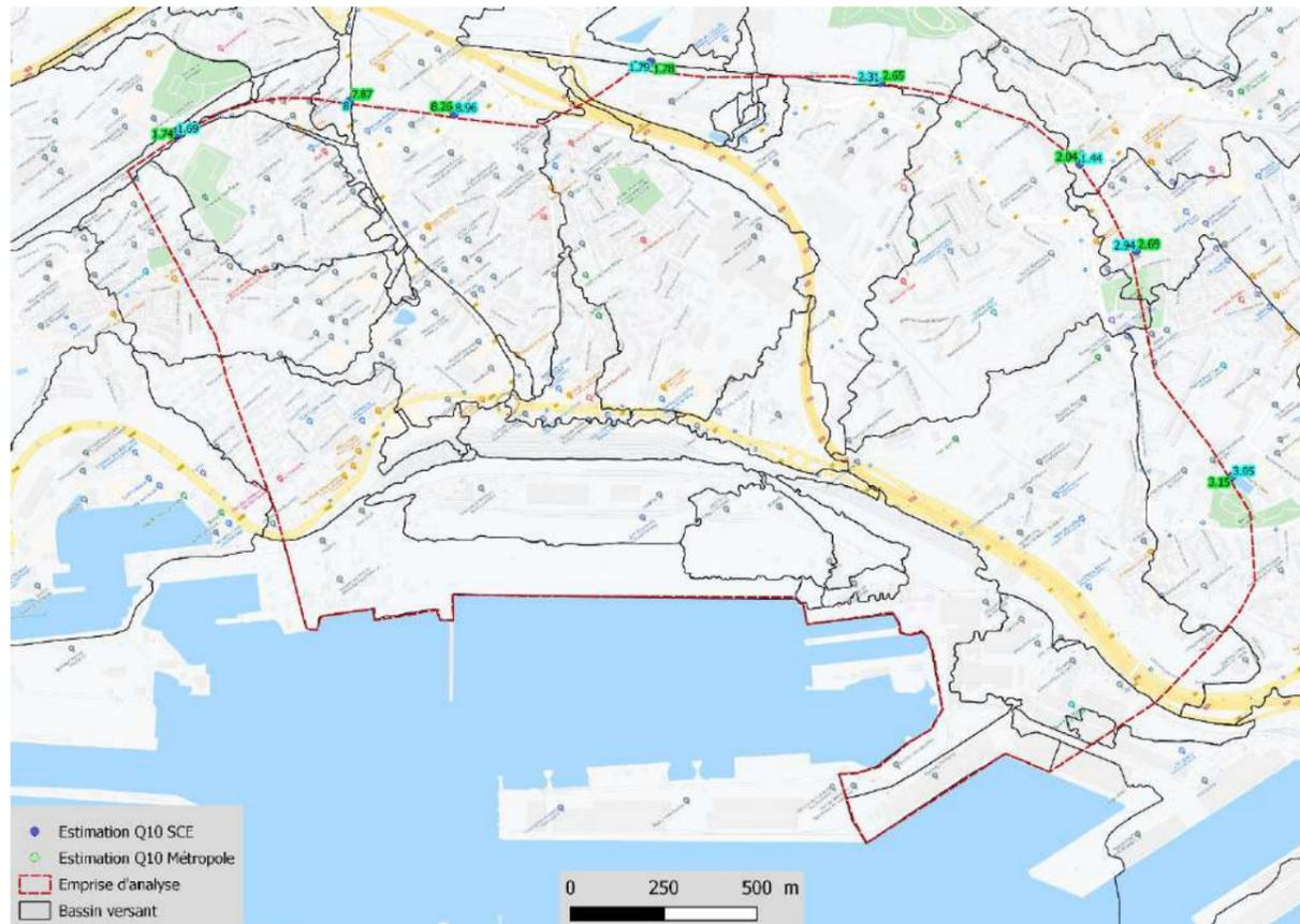
Figure 33 : Comparaison des débits de pointe (en m<sup>3</sup>/s) entre la Métropole et SCE pour une occurrence décennale (en m<sup>3</sup>/s)
