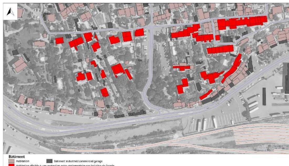
Figure 326 : Identification des bâtiments dépassant les seuils d'émergences admissibles : 5 dB(A)
