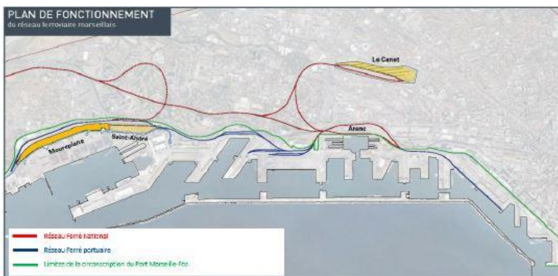
Figure 1 : Plan de fonctionnement du réseau ferroviaire marseillais
