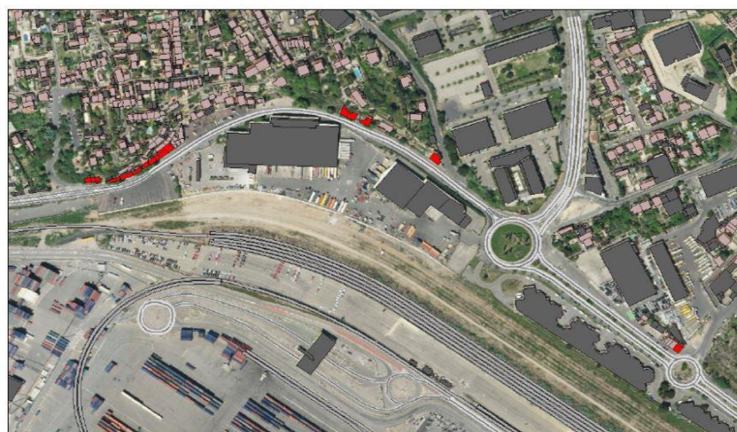
■ : Bâtiment dépassant les seuils acoustiques PNB (LAeq(6h-22h) > 73.0 dB(A) et/ou LAeq(22h-6h) < 68.0 dB(A)).
